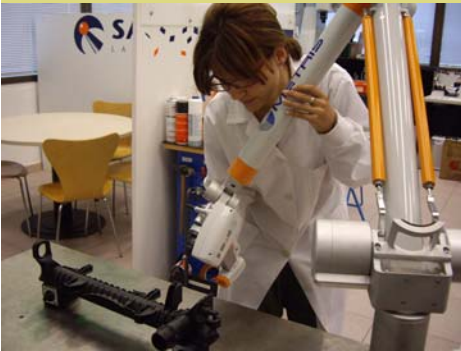
Medición de pieza de plástico con brazo portátil
