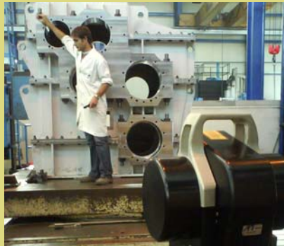
Medición de caja de engranajes con Laser Tracker
